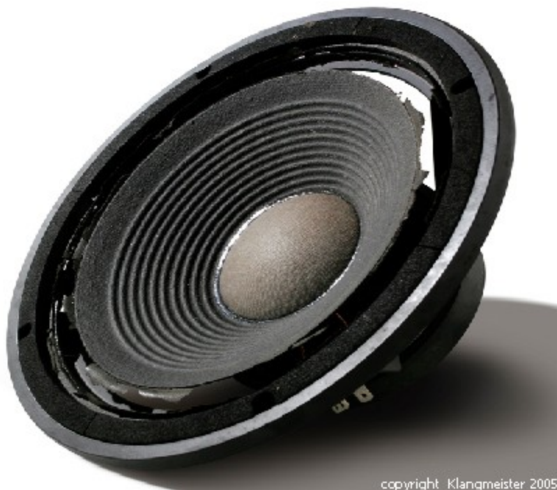
Abbildung 1: JBL-Hochleistungschassis mit verrotteter Sicke
