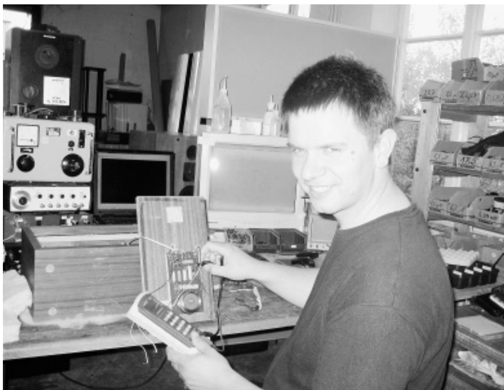
Arbeiten an der Frequenzweiche: Georg Stracke von „Klangmeister“ überprüft betagte Lautsprecherbauteile auf ihre Funktion.
